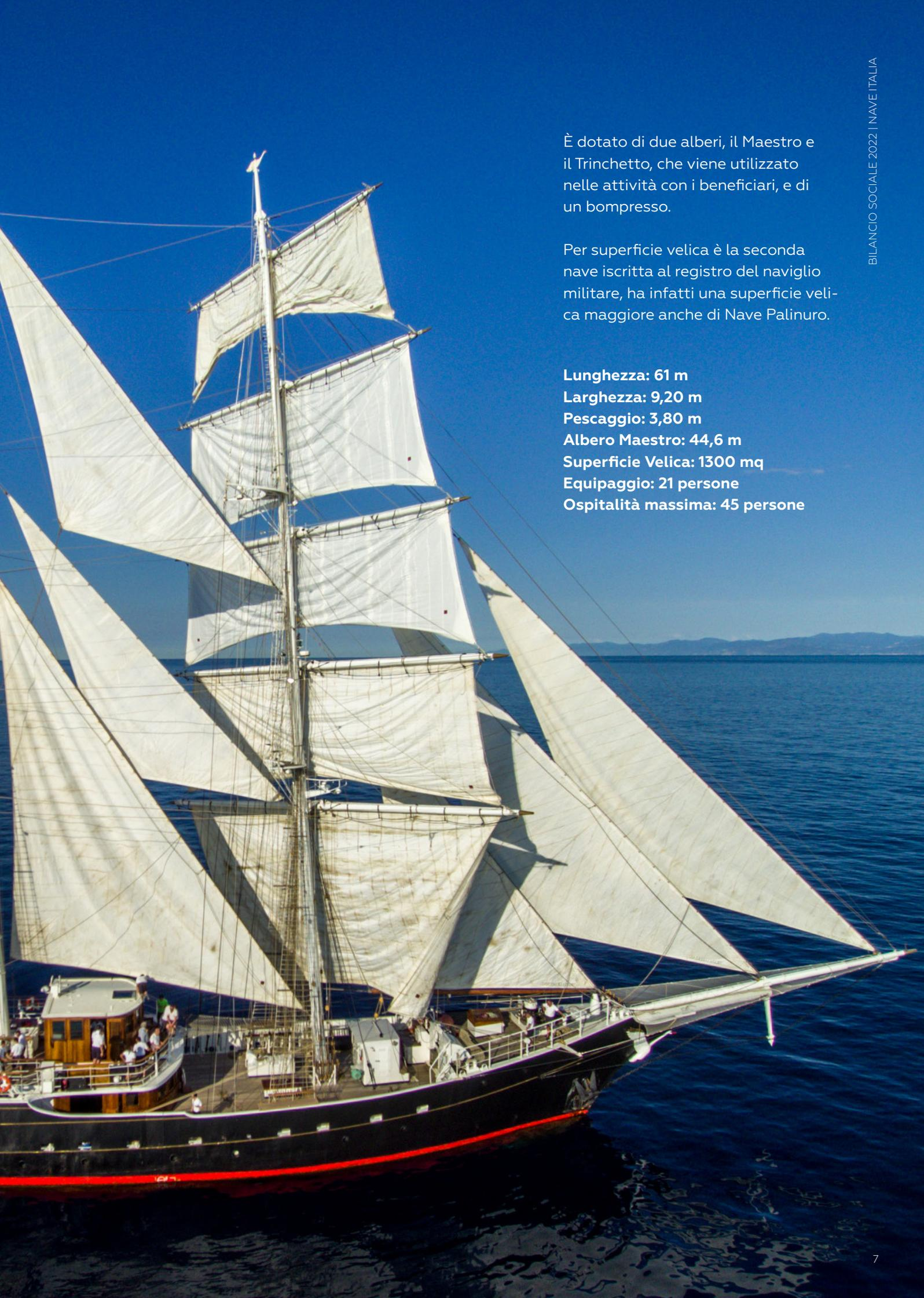
È dotato di due alberi, il Maestro e il Trinchetto, che viene utilizzato nelle attività con i beneficiari, e di un bompreso.
